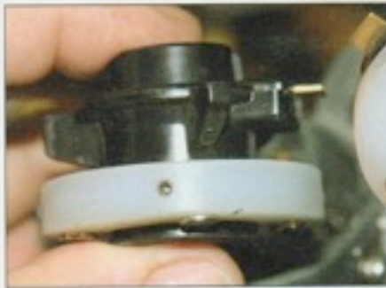
14 Remonter le plateau, la capsule à dépression et les ressorts de maintien de la tête d'allumeur.
