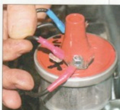
6 Connecter le fil d'alimentation du calculateur.
