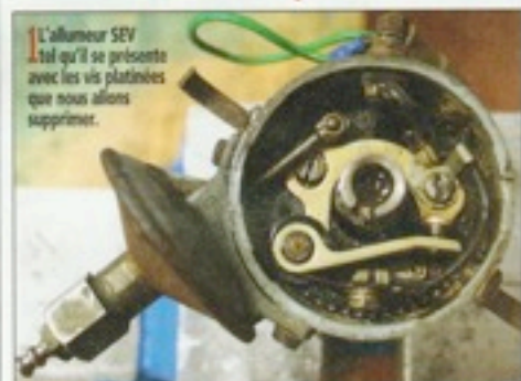
2 Première étape : un démontage complet pour extraire les vis (linget fixe et linget mobile), déposer le condensateur ainsi que la capsule d'avance à dépression.
