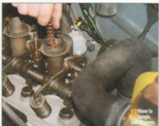
17 Introduire l'ensemble dans le puits de bougie du quatrième cylindre.
