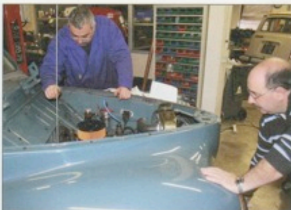
31 Insérer la pigne et continuer à tourner très lentement jusqu'à ce qu'elle pénètre dans son encoche. La lampe doit s'allumer. Sinon, affiner le réglage en tournant l'allumeur. Retirer la pigne et faire un tour de vilebrequin pour mettre le premier cylindre en explosion (soupapes du quatrième cylindre en balance). Vérifier et affiner au besoin le calage.
