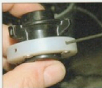
17 Le serrer légèrement afin qu'il puisse tourner pour réaliser le réglage du point d'allumage.
