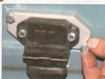
2 La masse étant faite par le corps du boîtier du calculateur, nous avons poncé la peinture derrière les deux fixations. Mettre en place les vis avec une rondelle éventail.
