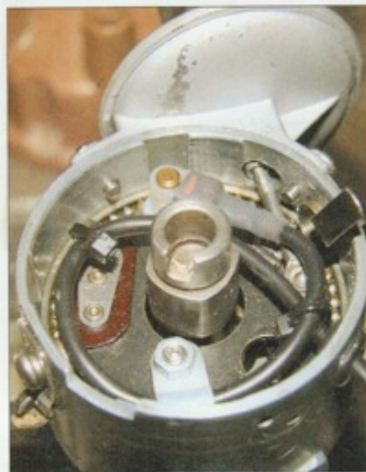
19 Le pousser à fond de démonteur et vous assurer que l'ensemble rotor-disque-arbre d'entraînement tourne sans point dur.
