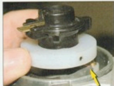
20 Vérifier que le disque passe entre 1 et 3 mm au-dessus du trait rouge du capteur.
