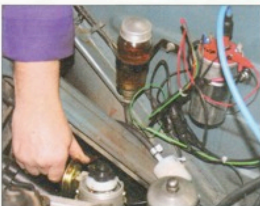
27 Si ce n'est pas le cas, tourner légèrement l'allumeur jusqu'à ce qu'elle s'allume pleine intensité.
