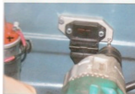
1 Dans un premier temps, nous avons choisi d'installer un allumage électronique Multic (il conserve masselottes, avance à dépression et vis platinées). C'est un calculateur qui gère la course d'avance. Nous le montons sur la contre-alie gauche après avoir percé deux trous.
