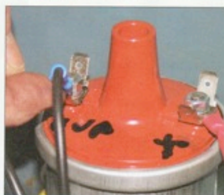
5 La bobine est déjà reliée au faisceau électrique. Connecter le fil rupteur en provenance du calculateur.
