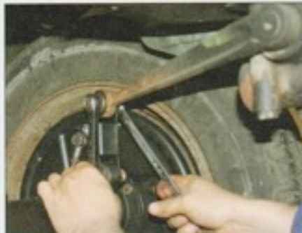
L'erreur est humaine ! Nous avons monté les jumelles d'amortisseurs vers le haut. Tout faux, car dans cette configuration, le levier d'amortisseur est en position... haute. Il n'a plus de débattement. C'est donc vers le bas qu'il aurait fallu l'orienter, levier abaissé au maximum. On est bon pour tout démonter...
