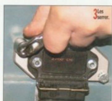
2 La masse étant faite par le corps du boîtier du calculateur, nous avons poncé la peinture derrière les deux fixations. Mettre en place les vis avec une rondelle éventail.
