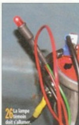
22 Connecter la lampe témoin, fournie avec le kit Multic, au fil vert.
