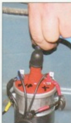
21 Connecter le fil à la bobine. Cette procédure n'est évidemment valable que pour caler un allumage électronique Multic.
