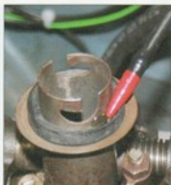
38 Huiler les joints caoutchouc des puits de bougies.
