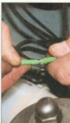
22 Connecter la lampe témoin, fournie avec le kit Multic, au fil vert.
