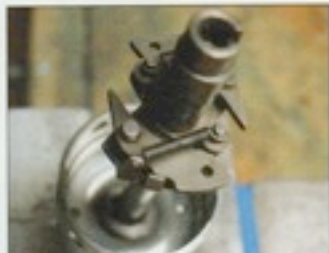
12 Les masselottes sont bridées pour supprimer l'avance centrifuge, celle-ci étant désormais gérée électroniquement. Positionner l'arbre assemblé.
