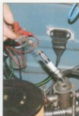
35 Déposer la bougie avec son ressort.
