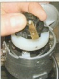
19 Le pousser à fond de démonteur et vous assurer que l'ensemble rotor-disque-arbre d'entraînement tourne sans point dur.
