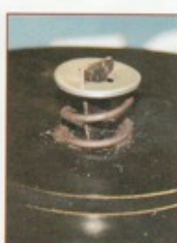
32 Plusieurs systèmes de verrouillage existent. Nous n'en avons pas et nous en avons fabriqué un avec un ressort et une rondelle.
