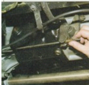
C'est un passionné de 203, Michel Duriez, qui nous a fait parvenir la tige de commande d'embrayage conforme à l'origine. Il trouvait, à juste raison, que notre bout de tige filétée ne faisait pas très sérieux ! Merci Michel.
